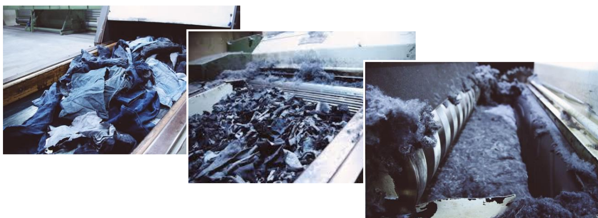
Figur 20. Mekanisk återvinning med klippning och rivning till korta fibrer. Källor: Stylo Urbano och MUD Jeans .
